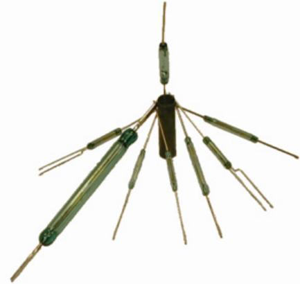
Un interrupteur REED est constitué de deux lames en matériau magnétique scellées à l'intérieur d'un tube de verre contenant un gaz neutre. Les lames sont disposées avec un léger recouvrement au niveau des contacts à l'intérieur du verre, espacées de quelques centièmes de millimètre entre elles (entrefer).
