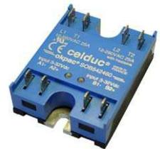
➤ Relais statiques biphasés avec entrées doubles avec connecteur type CE100F ITWPANCON ou équivalent ainsi que la connectique de puissance par cosses FASTON 6,3mm protégées contre le toucher.
