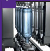
使用热空气进行 吹塑拉伸
