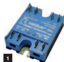
Relais statiques biphasé type SOB, pilotant des résistances de chauffe câblées en triangle. Adapté uniquement à des charges haute tension, équilibrées ou non.
