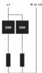
Contrôle de 2 résistances de chauffe câblées en monophasé.
