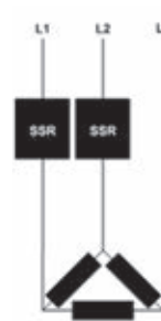
Relais statiques biphasé type SOB, pilotant des résistances de chauffe câblées en triangle. Adapté uniquement à des charges haute tension, équilibrées ou non.
