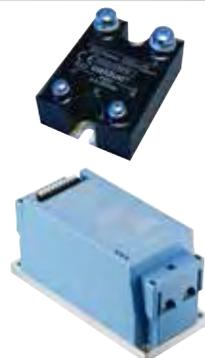
I prodotti senza protezione (transil o varistor (VDR) o protetti soltanto da un diodo devono essere dotati di una protezione esterna contro le sovratensioni. La tensione massima d'utilizzazione è allora sovente uguale alla metà della tensione commutabile massima specificata.
