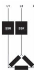
Rele' statici bifasi tipo SOB, pilotano delle resistenze cablate a triangolo. Adatto a carichi in alta tensione, equilibrati o non.
