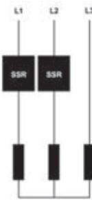
Rele' statici bifasi tipo SOB, pilotano delle resistenze cablate a stella. Adatto unicamente a carichi in bassa tensione equilibrati e senza neutro.
