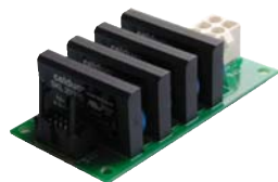
4 твердотельных реле SKL на печатной плате
