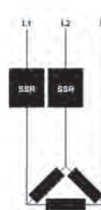
Двухфазное ТТР SOB для контроля нагревательных элементов, соединенных треугольником (для сбалансированных или несбалансированных нагрузок высокого напряжения)
