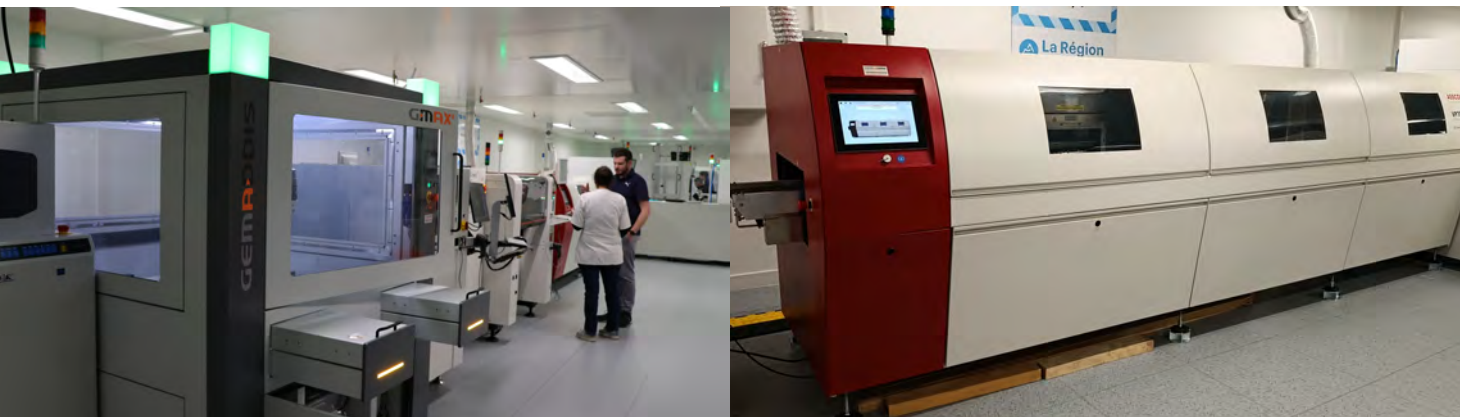
Four phase vapeur pour refusion avec mise sous vide et refroidissement
